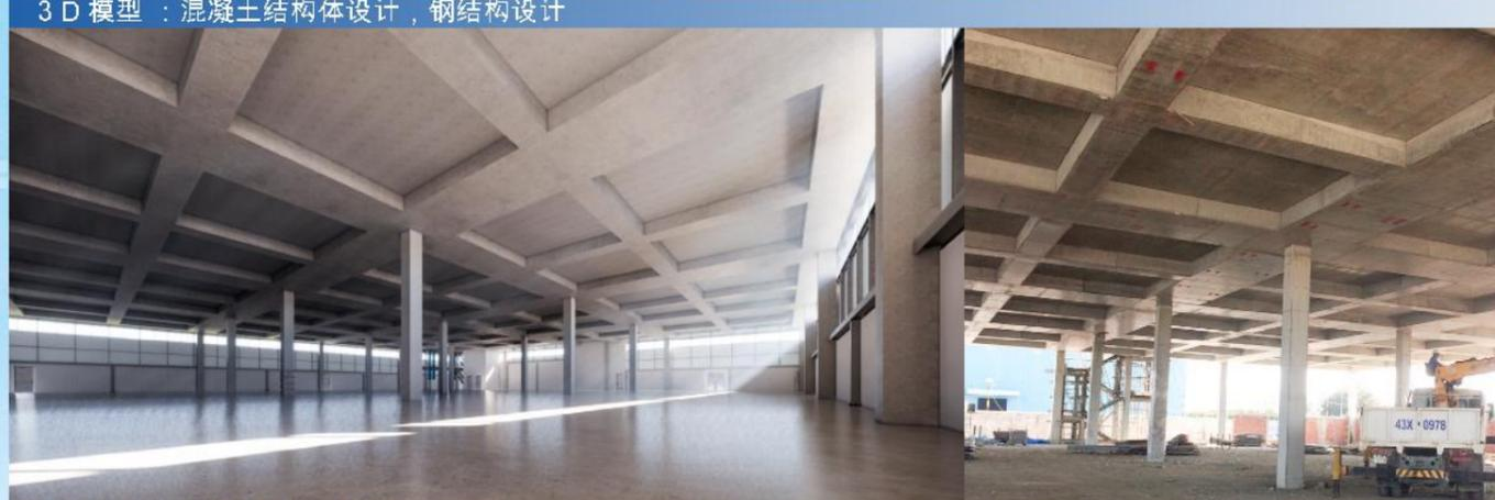
3 D 模型：预力混凝土板设计
